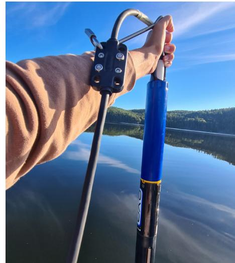
Sonde til bruk ved vertikalprofil av vannsøylen i innsjøer.
