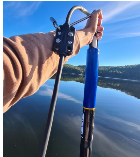
Sonde til bruk ved vertikalprofil av vannsøylen i innsjøer. Foto: Norconsult
