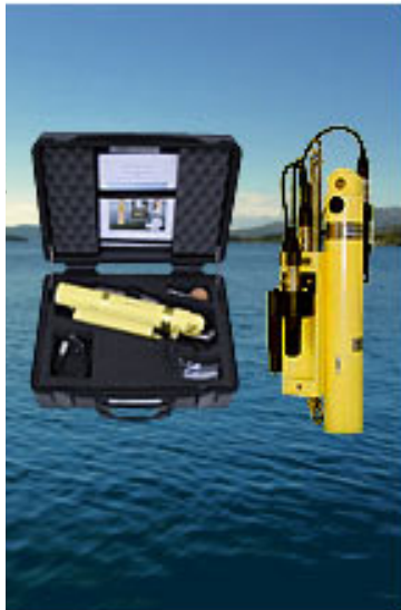
Figur 6. CTD-sonden (SAIV 204) som ble brukt til måling av temperatur- og oksygenprofiler.
